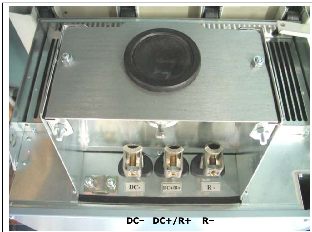
Obr. 6-20. Svorky JS medziobvodu a brzdného odporu pre FR9; Svorky JS medziobvodu sú označené DC- a DC+, svorky brzdného odporu sú označené R+ a R-
