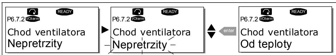
Obr. 7-22. Funkcia riadenia ventilátora
